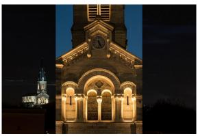
4 projecteurs linéaires de la famille CLEM - 565x de 70cm de long (réalisés sur mesure pour ce projet), montés sur des pattes de fixation orientables permettent la mise en valeur des baies centrales du clocher.
