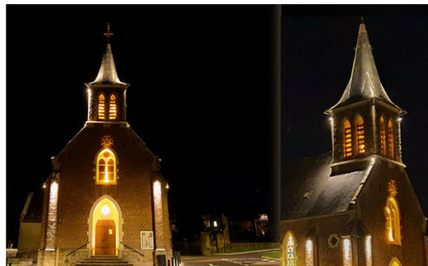
Des barreaux lumineux **Clem (5651)** installés à la verticale, à l'intérieur du clocher, mettent en valeur les vitraux.
